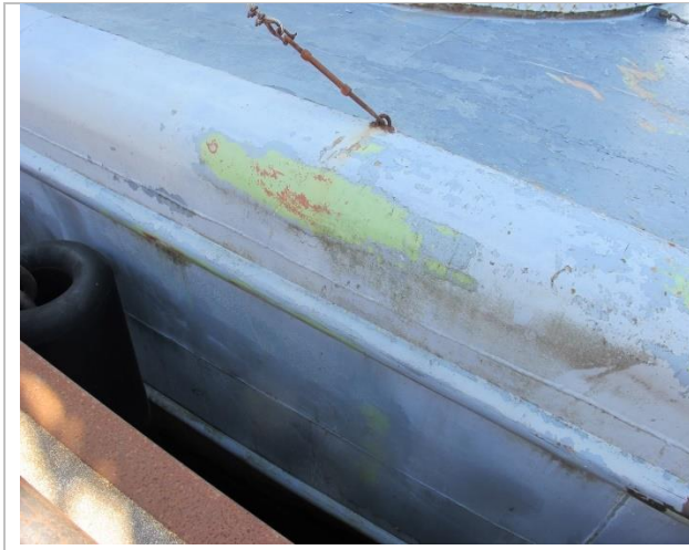
Virsbūvei 3 līdz 4 iepriekšējās krāsas un grunts slāņi
