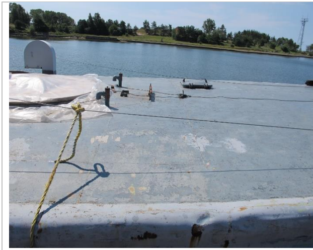
Virsbūvei 3 līdz 4 iepriekšējās krāsas un grunts slāņi
